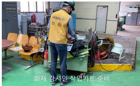
안전관리자 현장점검 후 작업승인 (소화기, 방열포, 화재 감시인, 확성기, 휴대 조명, 방연 마스크 등)
