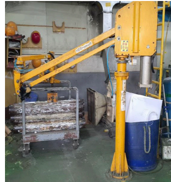
코터 와인더파트 중량물 이송장치 설치
