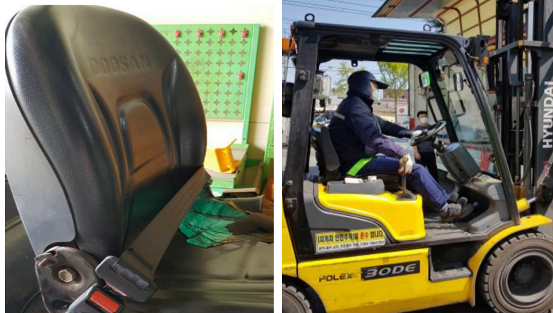
지게차 안전벨트 색상 변경 기존[검정] - 변경[형광]
